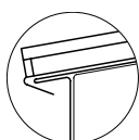
Felsbeëindiging recht (alleen voor optisch niet veeleisende toepassingen).
